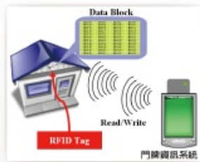
▲ 圖 2 RFID 資訊門牌系統
